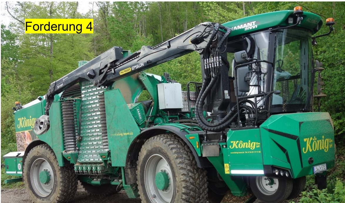
Häcksler Allrad Selbstfahrer, 790 PS, 940 l Dieseltank, Leistung bis zu 500 m 3 pro Stunde, Länge 10 m, Breite 2,55 m, Gesamtgewicht 32 Tonnen LKW für Hackschnitzeltransport wiegt 32-40 Tonnen (TW 17.04.2024)
